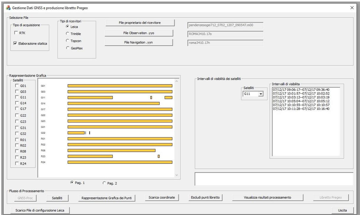
Figura 69 – Schermata di analisi del tracciato dei satelliti
