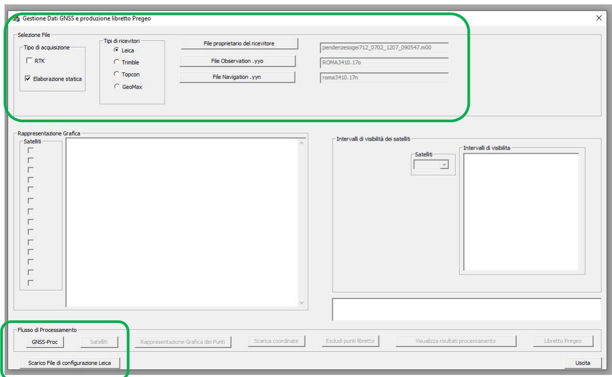
Figura 67 – Schermata di conversione file modalità Elaborazione statica
